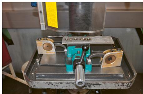
**3** Schraubstock mit Schnellspanneinheiten
