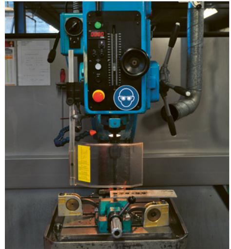
4 Verriegelte, trennende Schutzvorrichtung: schwenkbare Bohrer-Verdeckung
