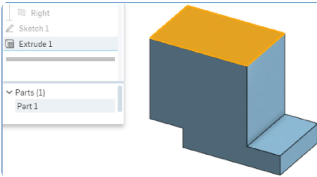
*Die Auswahl einer Fläche des Bauteils im Grafkbereich führt dazu, dass die „Linear austragen“-Funktion und der Bauteilname in der Feature- bzw. Bauteil-Liste hervorgehoben werden.*
