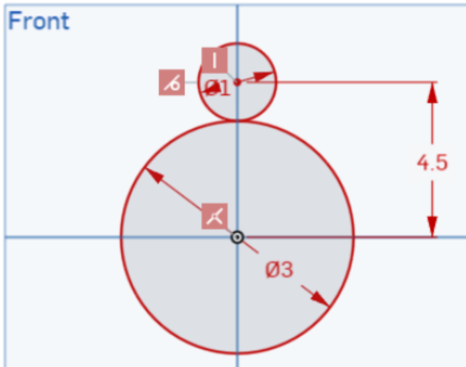
Eine überdefinierte Skizze: Fehler oder Konflikte werden in Rot angezeigt.
