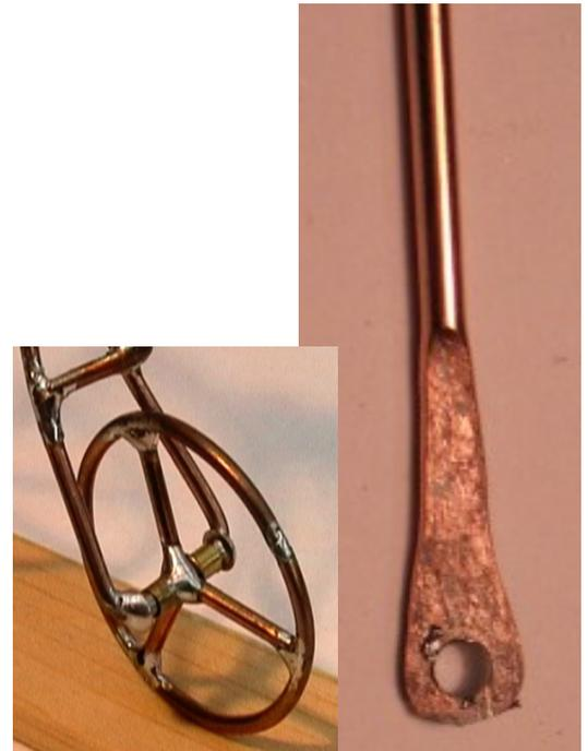
Diese Werkaufgabe führt Schüler zu präzisen Arbeiten in kleinen Details. Schwerpunkte der Arbeit sind: Weichlöten / Biegen von Draht / Kaltschmieden / Bohren in Metall. Wegen der vielen Bauteile ist es gut geeignet als Aufgabe zur Serienfertigung ( 2 Gruppen).
