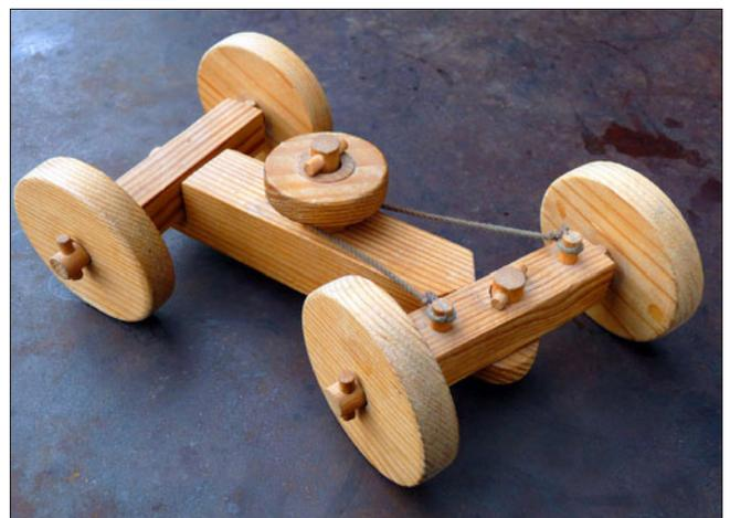
Holzauto mit Achsschemel-Lenkung und Pendelachse
