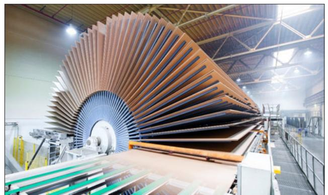
Platten beim Abkühlen im Kühlsternwender nach dem Pressen bei 250°C
