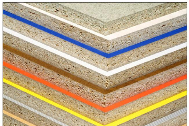
Spanplattenmuster mit unterschiedlichen Beschichtungen und Strukturen
