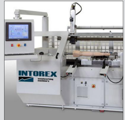
CNC-Drehautomat für die Serienproduktion
