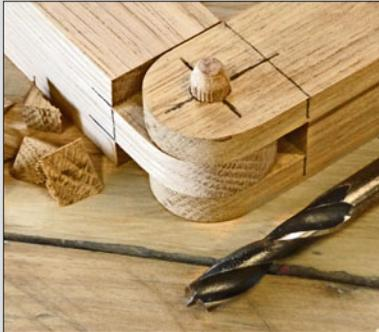
180°-Gelenk fertig montiert
