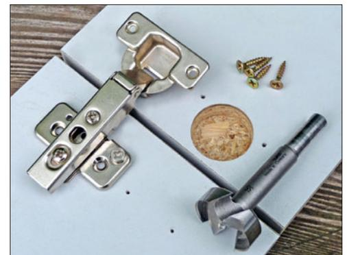
Bohrung und vorgestochene Schraubenlöcher
