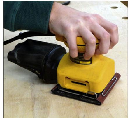
Der Faustschleifer ist ein sehr beliebtes Gerät und auch für den Anfänger gefahrlos zu handhaben.
