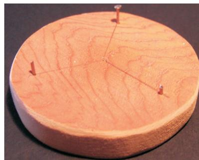
Wie links angegeben die Maße auf die erste Rundscheibe übertragen und 3 kleine Nägel in der Bohrlochmitte für die Rundstäbe einschlagen. Die Nagelköpfe abkneifen und beide Rundscheiben aufeinanderpressen. Seitlich beide Scheiben markieren; damit man sie später wieder in dieser Position zusammensetzen kann.
