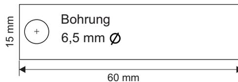
Leiste zuerst bohren, dann absägen. (Die Bohrung ist sehr nah am Rand und bricht dadurch leicht aus.)
