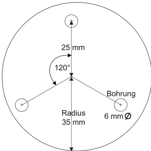
Für die 2 Rundscheiben verwendet man nicht zu dickes Weichholz, das sich gut mit der Laubsäge (oder Dekupiersäge) sägen lässt. Mit einem Reißzirkel den Mittelpunkt vorstechen und mit 35 mm Radius den Kreisbogen anreißen und aussägen.
