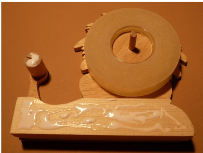
Die Sperrholz-Innenkreise der Tesafilmrolle mit 4,0 mm durchbohren und in die Tesafilmrolle hineinschieben.
