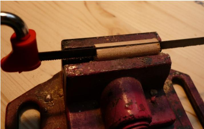
Ein Rundstab 10 mm wird mit einem Eisensägeblatt der PUKSäge eingesägt und danach auf die passende Länge abgesägt.
