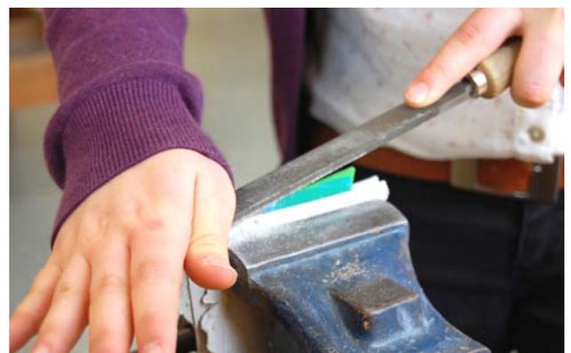
Kantenglättung mit der Feile in Längsrichtung
