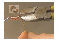
Dann zieht man die Spirale unter leichtem Drehen vom Rundstab und kneift mit dem Seitenschneider (Zange) einen Teilring ab (siehe links oben).
