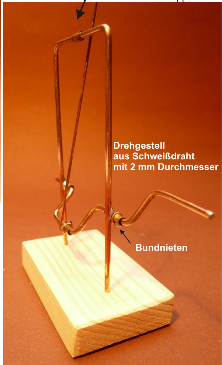
Drehgestell aus Schweißdraht mit 2 mm Durchmesser
