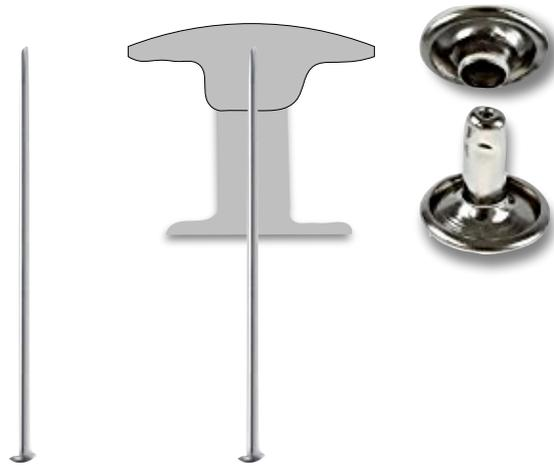
Damit die Reibung möglichst gering ist, dreht sich das Turbinenrad im Kopf der Hohlriete auf der Spitze einer Stecknadel.
