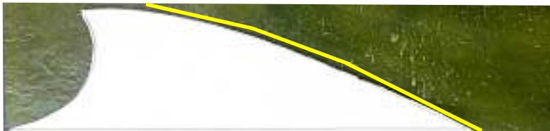
Dann fährt man mit dem Glasschneider entlang etwas außerhalb der vorgezeichneten Form (gelbe Linie). Der Glasschneider muss mit Druck zügig über das Glas geführt werden (schieben nicht ziehen). Dabei unterbricht er die Oberflächenspannung des Glases.
