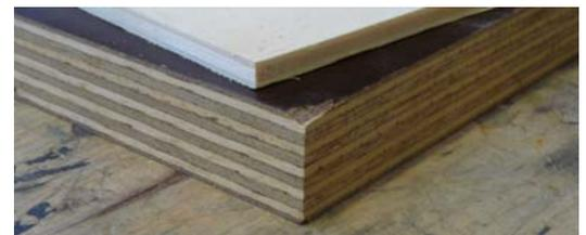
Dreischicht-Sperrholz und wasserfest verleimte Multiplexplatte
