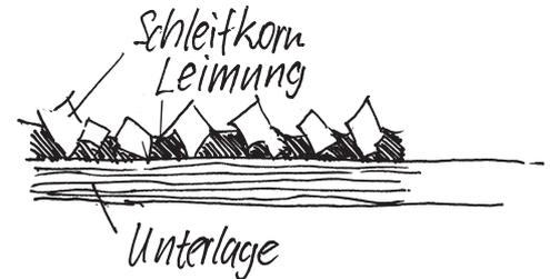
*Schematische Schnittdarstellung von Schleifpapier*
