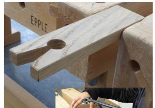
*In die Werkbank eingespanntes Laubsägebrett*
