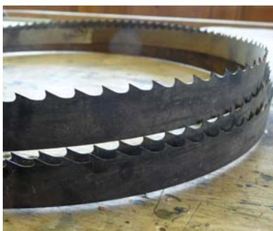
Zahnform an einem Bandsägeblatt
