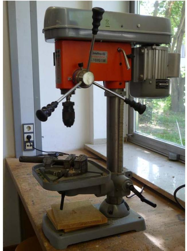
*Tischbohrmaschine mit Bohrschraubstock und bereitliegenden Bohrunterlagen*
