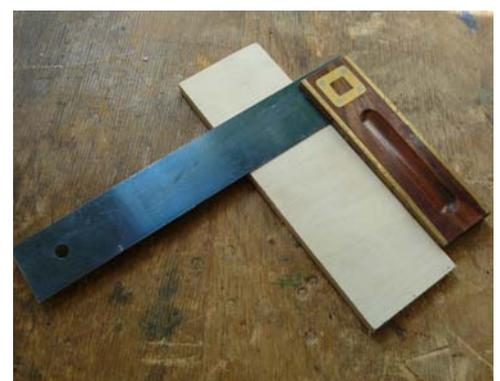
*Anschlagwinkel mit Stahlzunge und Messingbeschlag*
