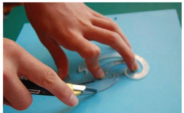
Abb. 4: Formschnitt mit einer Schablone
