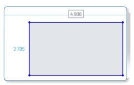
8. Geben Sie 4 für die Breite ein und drücken Sie die Eingabetaste. Das Höhenfeld wird sofort aktiv. Geben Sie 3 für die Höhe ein und drücken Sie die Eingabetaste. (Sie können diese Bemaßungen jederzeit bearbeiten oder löschen, wenn das Skizzen-Dialogfenster geöffnet ist.)
