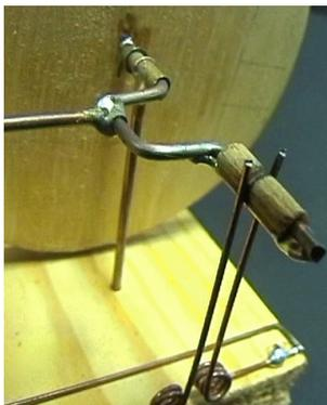
Ein Pol der Stromquelle (Transformator mit ca. 10V) ist durch einen Schleifkontakt mit der Antriebswelle verbunden. Über den Schleifkontakt oben erhält jeweils die Spule Strom, die mit ihrem Schleifkontakt die Messinghalbschale berührt.
