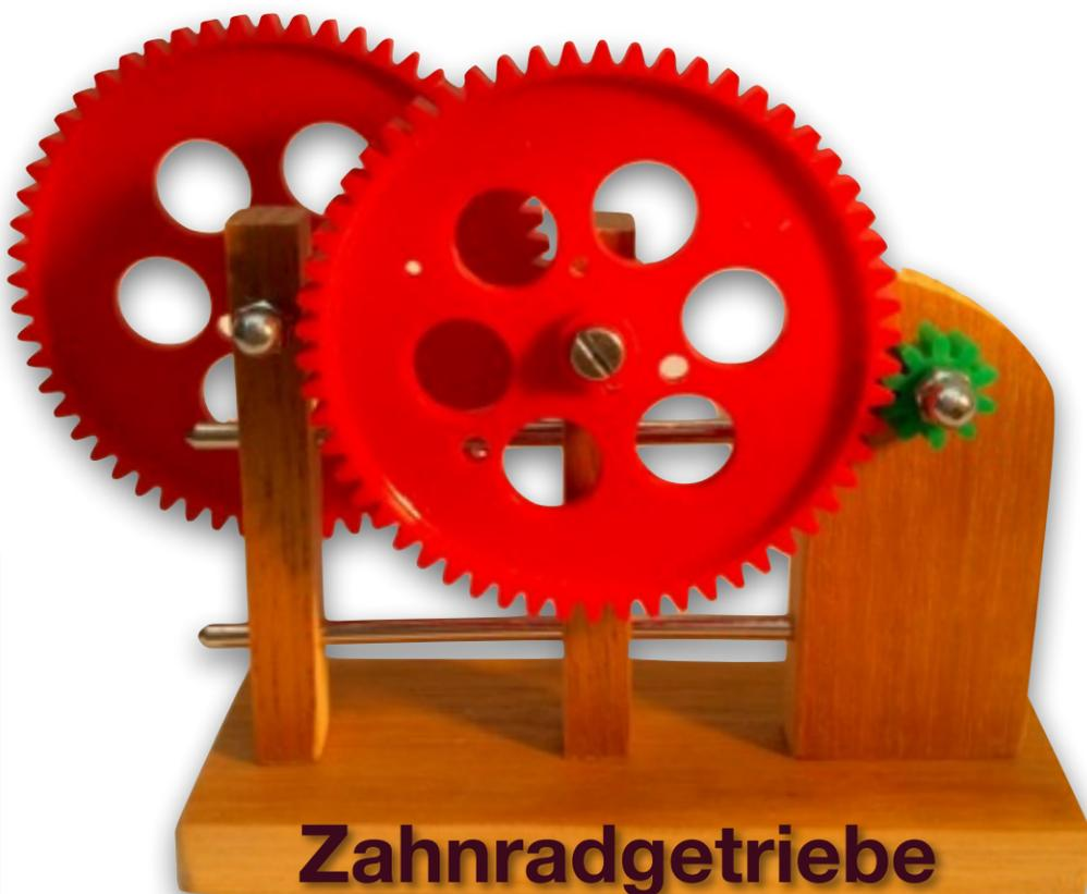
Die hier beschriebene Vorrichtung ermöglicht den einfachen Aufbau von unterschiedlichen Zahnradgetrieben. Die Leisten sind auf den 3 mm-Achsen verschiebbar angeordnet. Dadurch kann der Abstand der Zahnräder zueinander durch Verschieben exakt eingestellt werden.
