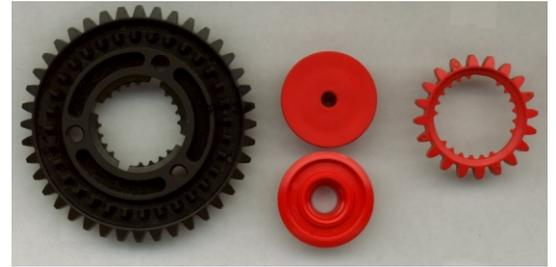
Zahnrad Z 40 Und Z 20 werden mit einer Radfelge auf der Achse befestigt.
