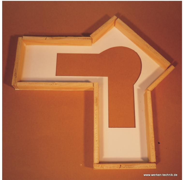
Das Motormodell wird stabiler, wenn Leisten von 12 mm Breite seitlich festgeleimt werden. Sie können später mit Papierstreifen kaschiert werden.
