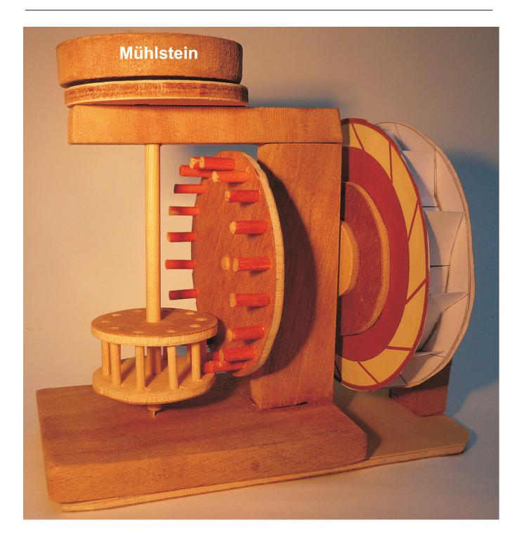
Funktionsmodell einer Wassermühle
